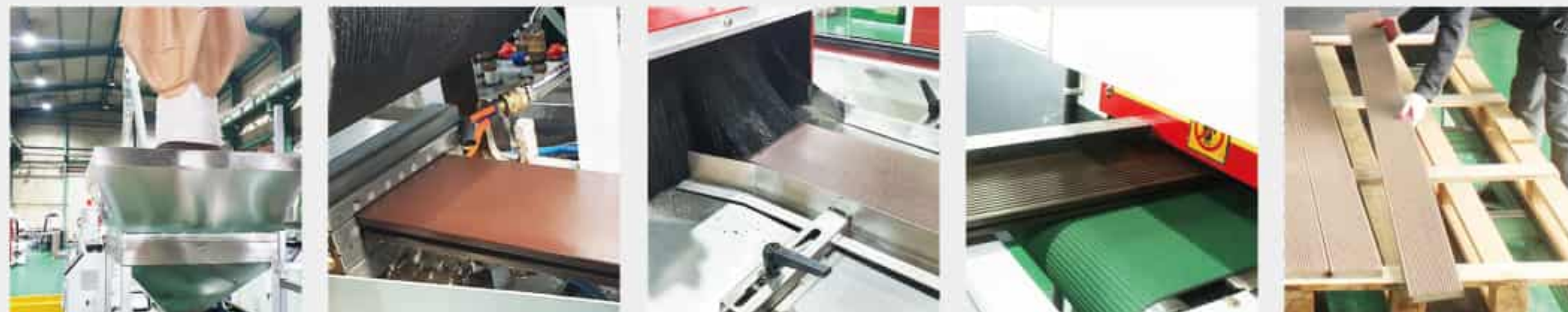
① 원료 준비 ② 압출 및 문양 작업 ③ 절단 작업 ④ 샌딩 작업 ⑤ 파렛트 포장
